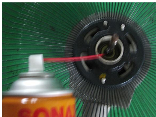
ภาพที่ 5.8 ฉีดน้ำมันหล่อลื่นที่แกนมอเตอร์พัดลม ที่มา : http://namcha.blogspot.com/2012/07/blog-post_28.html
