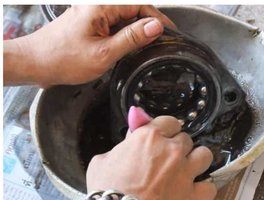
ภาพที่ 5.10 อัดจาระบีที่ตลับลูกปืนล้อรถ ที่มา : http://www.thailandoffroad.com/jeep/board/Question.asp?ID=47312
